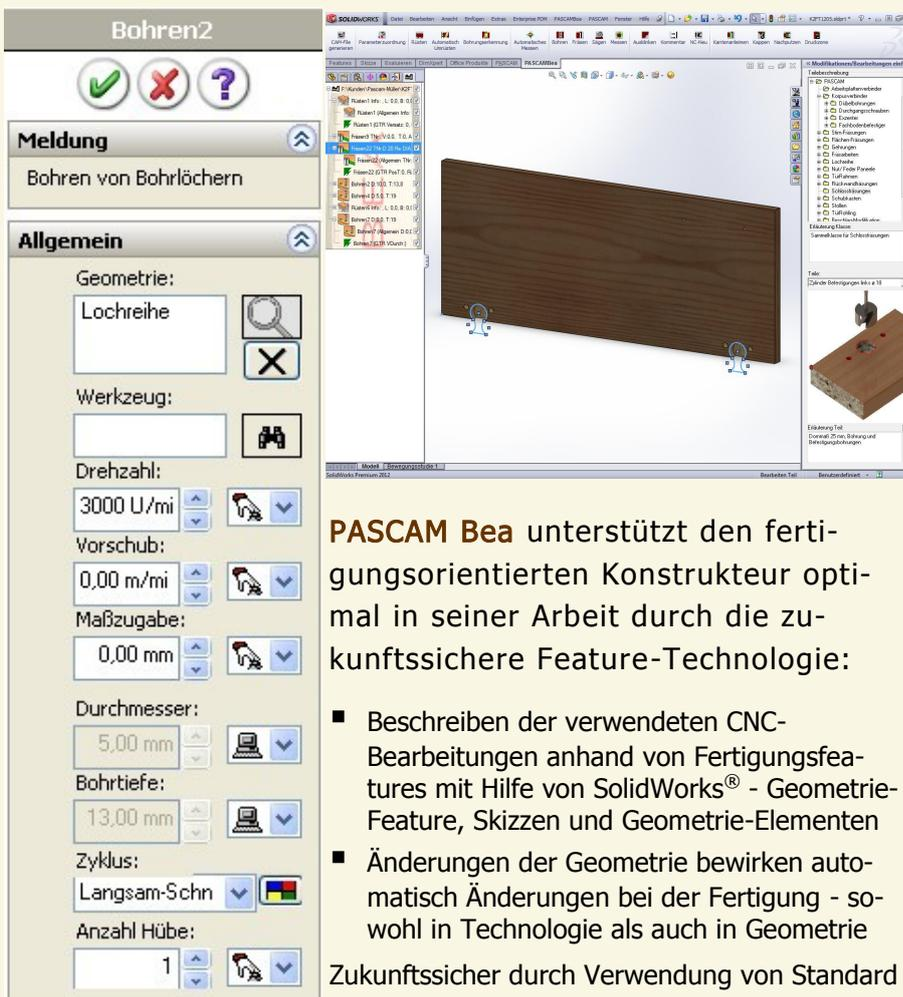
**PASCAM Bea** unterstützt den fertigungsorientierten Konstrukteur optimal in seiner Arbeit durch die zukunftssichere Feature-Technologie:
